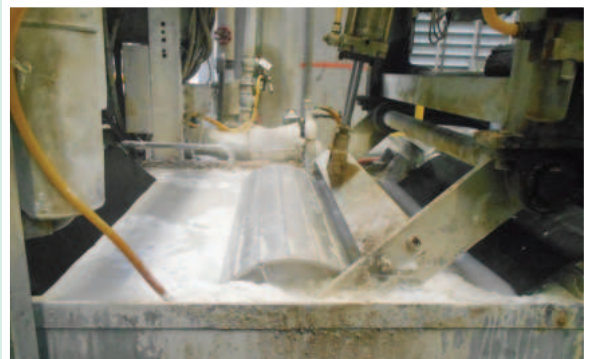
◆ การผสมน้ำแป้ง เครื่องรีดแผ่นยาง Anti-Tack Mixing by Rubber sheeting line Machine (Katame)
